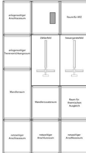
Abbildung 8: Bsp. Wandlermessung 200 A in Neuanlagen
