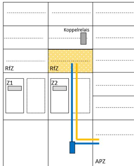
Abbildung 5: Zwei Zähler bei einer BKE-I Ausführung
