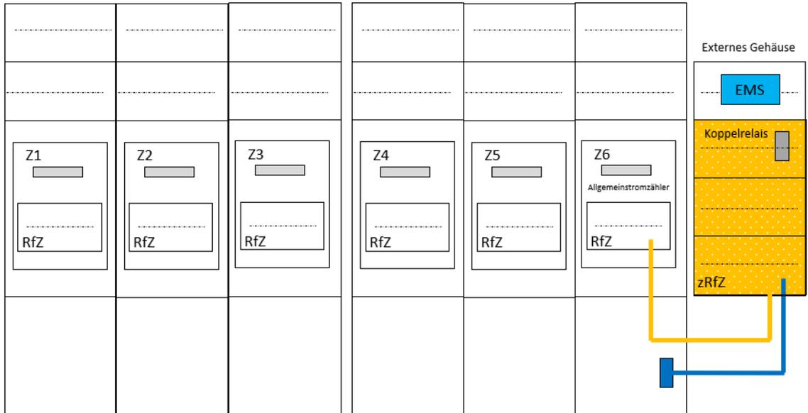
Abbildung 11: Bestandszählerplätze ohne zusätzlichen Zählerplatz bzw. Steuergerätefeld
